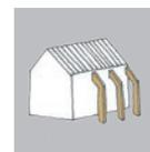
LVL材で作成した控え壁で補強する
